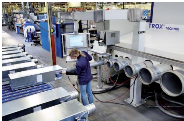
Výroba, kontrola a nastavení regulátorů průtoku vzduchu ve výrobním závodě
