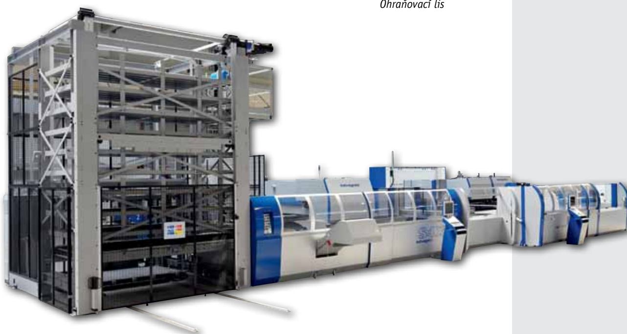
Špičkové obráběcí centrum plechu pro výrobu panelů
