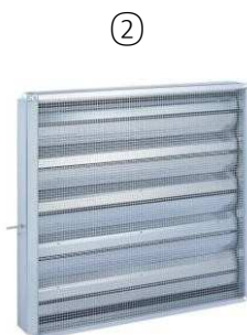
Izolovaná žaluziová klapka se servopohonem s vratnou pružinou, 24 V, otevírá bez proudu, namontovaná na straně sání.
